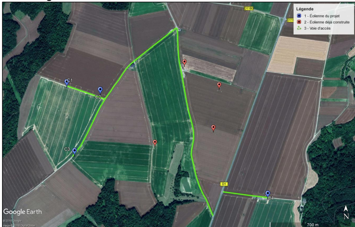
Figure 16 : Tracés des chemins d'accès aux éoliennes
